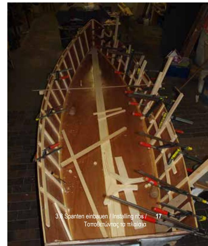
3.8 Spanen einbauen / Installing ribs /
